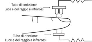
Figura 1 Principio di funzionamento
