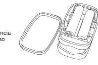
Figura 3 Instalación de las pilas
