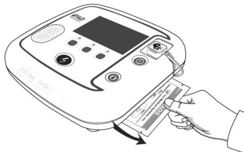
3. Insira o conector dos discos dos novos discos na Inserção do conector dos discos e depois coloque na Embalagem dos discos no Compartimento de armazenamento dos discos. Consulte a figura abaixo.
