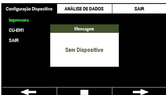
Verifique e seleccione um dispositivo da lista para o emparelhar com o CU-SP2. Depois de seleccionar, o CU-SP2 testará a ligação com o dispositivo seleccionado. Após testar, o CU-SP2 guardará as informações de ligação e regressará à página anterior.
