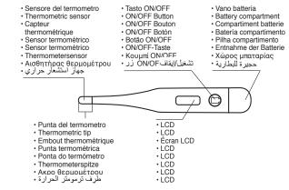
ATTENZIONE: il codice 25560 ha la scala di misura in  $^{\circ}$ C, il codice 25561 ha la scala di misura in  $^{\circ}$ F
