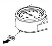
Retire a trava de transporte da parte inferior do aparelho.
