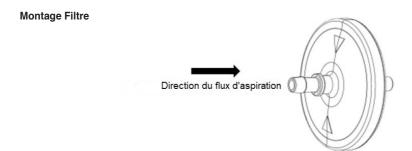
S'assurer que le filtre soit monté avec les flèches sur le côté du patient.
