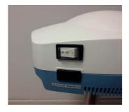
Un commutateur est situé à proximité de la prise pédale. Il a pour but de faire fonctionner le dispositif en question directement par le réseau électrique ou bien par le fonctionnement à pédale.
