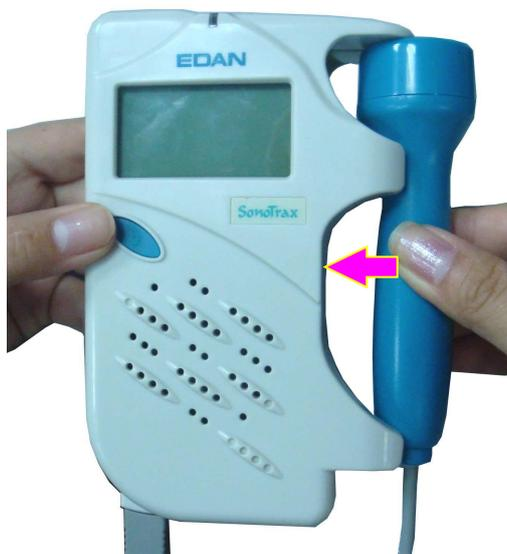
Figure 3-5 Fixation de la sonde sur son support
