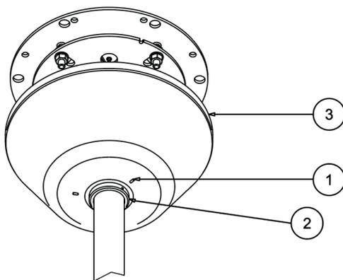
**Nel caso di quadro elettrico montato su tiges:** per accedere ai fusibili nella versione a soffitto, allentare i 3 grani (1) dell'anello (2). Sfilare verso il basso il copritiges (3).
