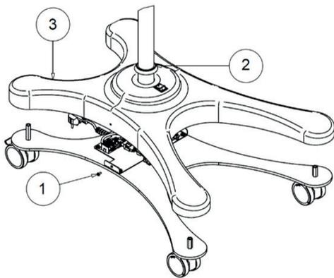
**Nel caso di versione a piantana:** per accedere ai fusibili nella versione a piantana rimuovere le viti (1), svitare i 3 grani a punta conica e sollevare l'anello di chiusura (2) e la copertura (3) lungo lo stelo.
