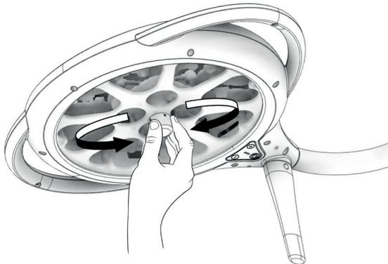
Per il modello PENTALED 28, è possibile ruotare in senso orario o antiorario il manipolo al centro dello schermo di protezione per regolare il diametro del campo luminoso e la messa a fuoco. Tale manipolo non è rimovibile e nemmeno sterilizzabile.
