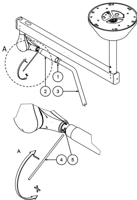
Far scorrere in avanti la guarnizione in silicone di tenuta (1) e la copertura (2) lungo il braccio a sbandamento (3). Inserire un perno (4) del diametro di 4 mm nei fori della ghiera (5) e ruotare nei sensi delle frecce per aumentare o diminuire la carica della molla.
