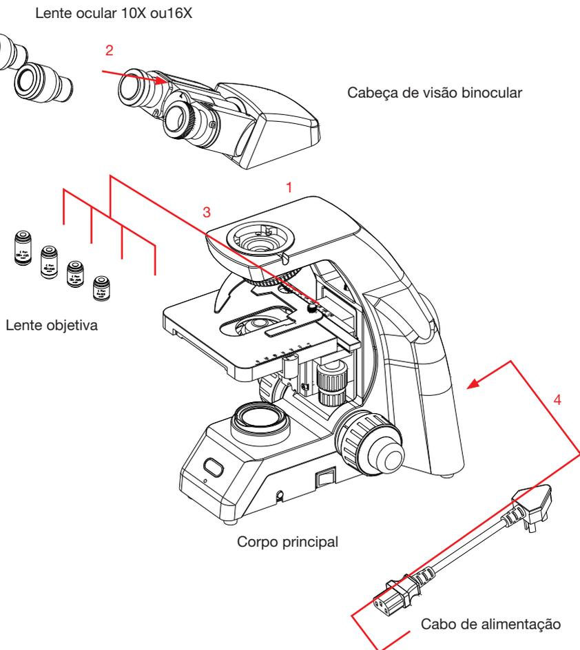
A figura seguinte mostra a sequência de instalação dos componentes. Os números na figura mostram os passos da montagem.
