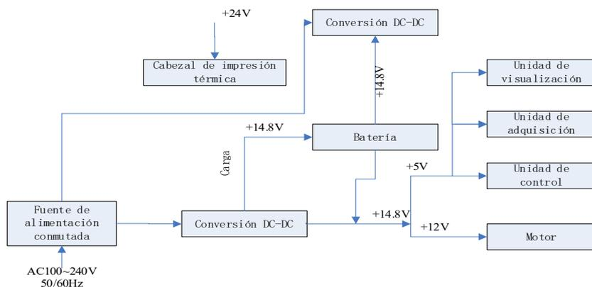
Figura 4-1 Diagrama de bloques del principio de potencia
