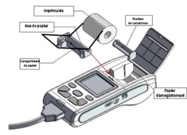
Figure 6 -1 Installation du papier d'enregistrement
