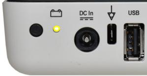
L'unità può essere messa in funzione mediante alimentazione di rete o usando la batteria ricaricabile incorporata. Il caricamento della batteria viene indicato da una spia LED sotto al simbolo della batteria.
