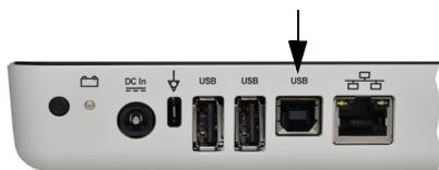
Non appena FT-1 acceso viene connesso a un PC tramite interfaccia USB tipo B, il dispositivo indica "Pronto per lo streaming".
