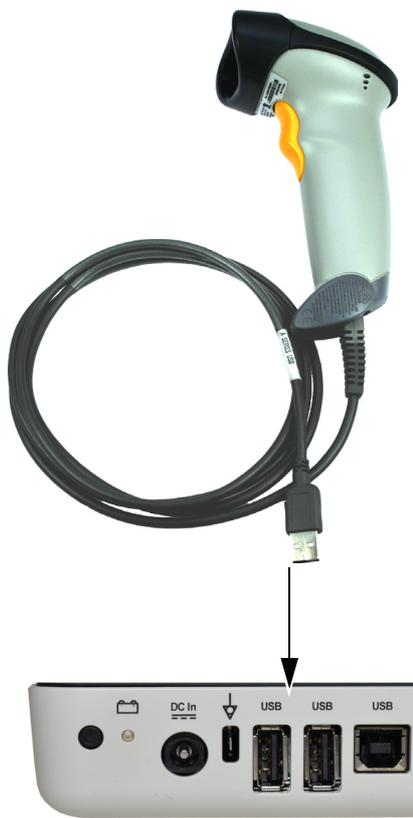
È possibile collegare un lettore di codici a barre alla porta USB sul pannello posteriore per leggere l'ID paziente/l'ID visita. SCHILLER ha testato il seguente lettore di codice a barre:
