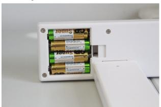
La visualizzazione sul display del simbolo — indica un livello di carica delle batterie basso. Bisogna sostituire quanto prima le batterie con delle nuove.
