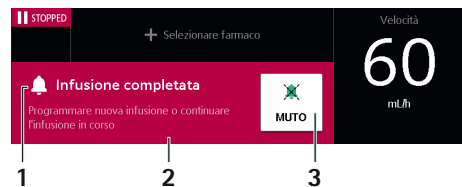
Figura 2: Display di un allarme operativo 1. Titolo allarme, 2. Istruzioni su come correggere la causa dell'allarme, 3. Pausa del segnale di allarme/Riduzione della finestra di allarme.
