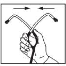
Pour réduire la tension du ressort de la lyre, saisissez les extrémités de la lyre et écartez-les doucement. Répétez l'opération jusqu'à obtention de la tension souhaitée.
