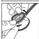
Pour remonter la membrane Littmann, retirez la bague anti-froid de la cloche. Insérez le bord flexible de la membrane dans la rainure du rebord et enroulez délicatement le rebord tout autour du bord du pavillon.
