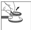
Para remover a membrana adaptável Littmann, aperte a borda da membrana com as unhas do polegar e indicador; puxe e levante a membrana da campânula.
