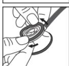
A Littmann hangolható membrán visszahelyezéséhez távolitsa el a meleg tapintató harangkarimát és a füldugókat (összeszerelés előtt győződjön meg róla, hogy minden alkatrész és felület száraz). A füldugók fejhallgatóról történő eltávolításához határozottan húzza meg azokat. A füldugók visszahelyezéséhez tolja a füldugó kisebb felét a fülcsőre, amíg teljesen a helyére nem pattan.
