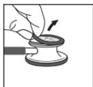
Para retirar la membrana de doble frecuencia Littmann, pellizque el aro de la membrana con las uñas de sus dedos índice y pulgar, tire y levante la membrana de la pieza torácica.
