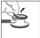
Για να αφαιρέσετε το ρυθμιζόμενο διάφραγμα Littmann, τομητήστε τη στεφάνη του διαφράγματος με τα νύχια του αντίχειρα και του δείκτη σας. Τραβήξτε και ανασηκώστε το διάφραγμα από τον κώδωνα.
