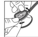
Verwijder de antikouding om het instelbare Littmann-membraan weer te monteren. Plaats de flexibele rand van het instelbare membraan in de groef van de rand en duw de flexibele rand voorzichtig rondom en over de rand van het borststuk.
