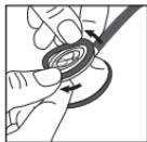
Para voltar a montar a membrana adaptável Littmann, remova a manga da campainha anti-arrepios. Introduza a borda flexível da membrana adaptável na ranhura do rebordo e enrolle vagarosamente o rebordo em volta e por cima da borda da campânula.
