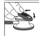
Chcete-li připevnit nechladivý kryt zvonu, umístěte jednu stranu krytu na okraji hrudního snímače a přetáhněte kryt přes a okolo okraje hrudního snímače.
