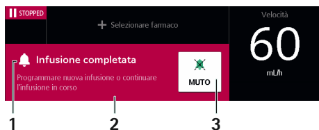
Figura 2: Display di un allarme operativo 1. Titolo allarme, 2. Istruzioni su come rettificare la causa dell'allarme, 3. Pausa del segnale di allarme/Riduzione della finestra di allarme.
