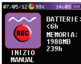
Questa schermata mostra soltanto le informazioni sullo stato dello strumento e consente di avviare manualmente la registrazione di un test. L'icona "AVVIO MANUALE" viene visualizzata come selezione predefinita. Il paziente non può modificare la configurazione dello strumento.
