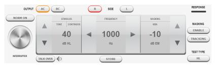
*Uscita*. Permette di scegliere il trasduttore da utilizzare (VA o VO). Il segnale di mascheramento è in ogni caso inviato per via aerea.
