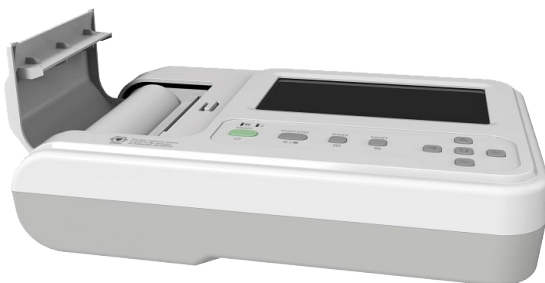
Figura 6-1 Installazione della carta di stampa
