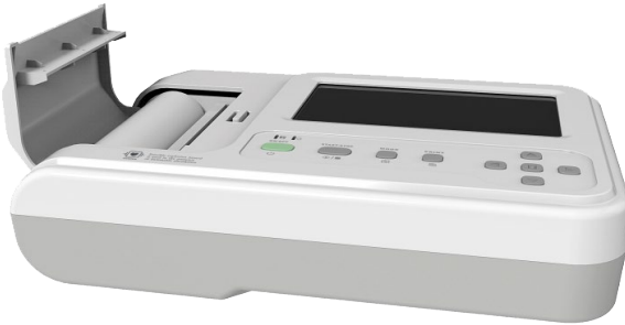
Abbildung 6-1 Auffüllen von Aufzeichnungspapier
