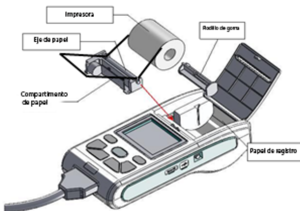
Figura 6-1 Instalación del papel de registro
