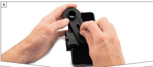
Successivamente, posizionate quindi l'adattatore davanti alla fotocamera dello smartphone: per farlo, allentate la vite di regolazione dell'adattatore, in modo che questo possa spostarsi lateralmente senza fatica e che possa muoversi in avanti e indietro.
