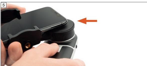
Il magnete dell'adattatore trattiene ora lo smartphone sull'anello di messa a fuoco del dermatoscopio.
