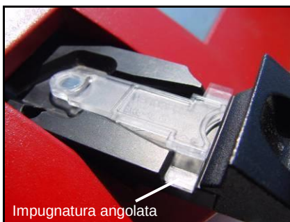
Figura 16 - Cuvetta non posizionata correttamente
