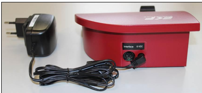
Figura 2 - Conexión del bloque de alimentación
