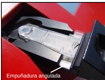
Figura 16 - Cubeta colocada incorrectamente
