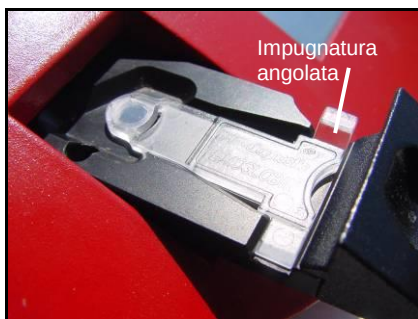
Figura 15 - Cuvetta posizionata correttamente
