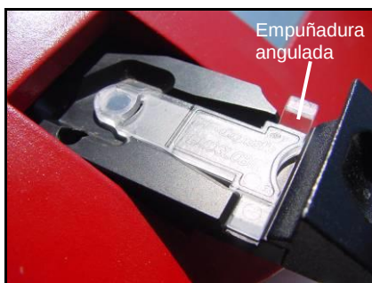
Figura 15 - Cubeta colocada correctamente
