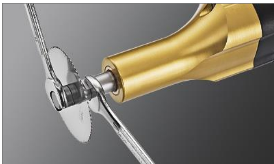
Fig. 1: Desserrer la vis de maintien
