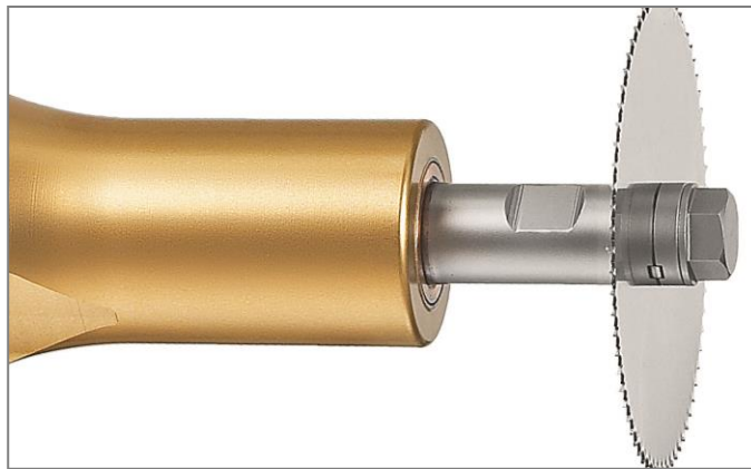
Abbildung 2: Einsetzen des Sägeblattes
