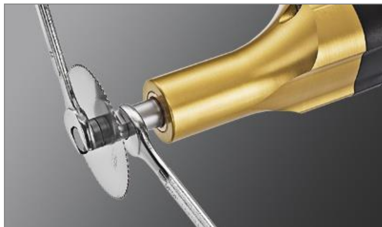
Abbildung 1: Lösen der Halteschraube
