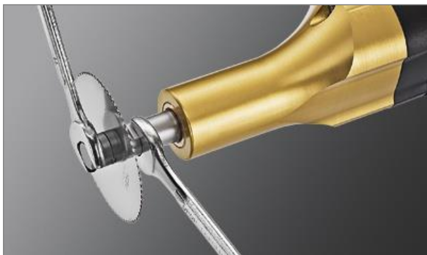
Ilustración 1: Soltado del tornillo de sujeción
