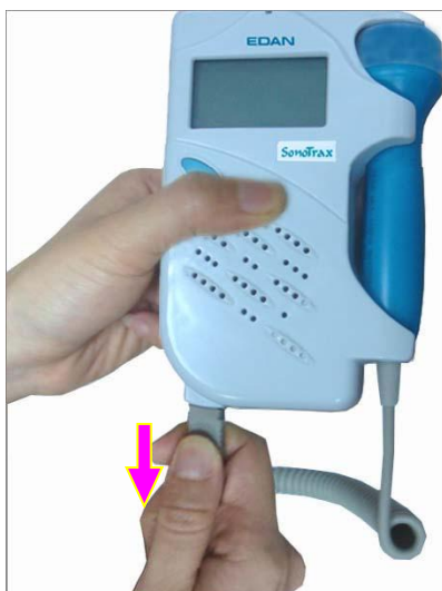
Figura 3-6 Retirada de la sonda
