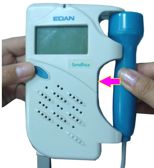
Figura 3-5 Posizionamento della sonda
