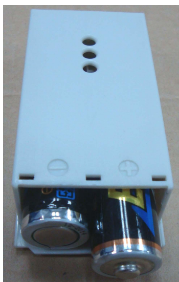
Рисунок 3-2. Установка батарей на крышку отсека
