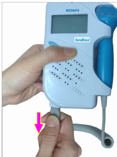
Abbildung 3-6 Entfernen der Sonde
