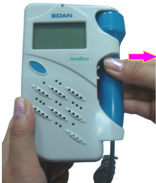
Figura 3-4 Estrazione della sonda
