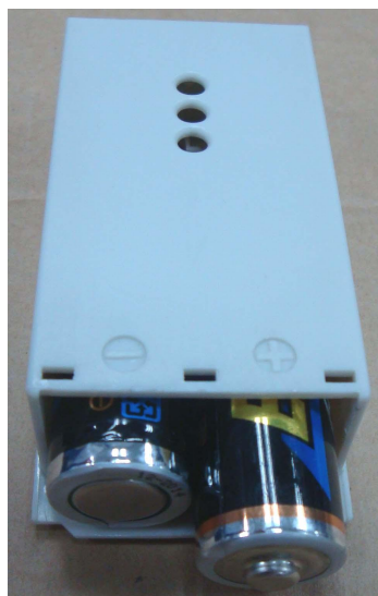
Figura 3-2 Colocación de las pilas en el compartimento
