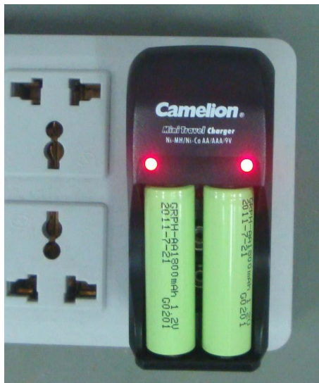
Figura 3-7 Recarga da bateria NI-MH
