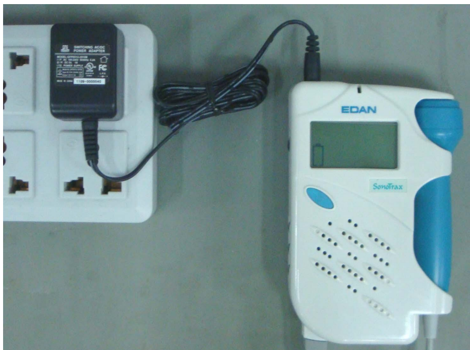
Abbildung 3-7 Laden des NiMH-Akkupacks
