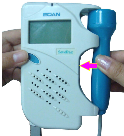
Figura 3-5 Colocación de la sonda
