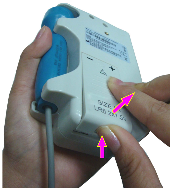
Figura 3-1 Abertura do compartimento de bateria
