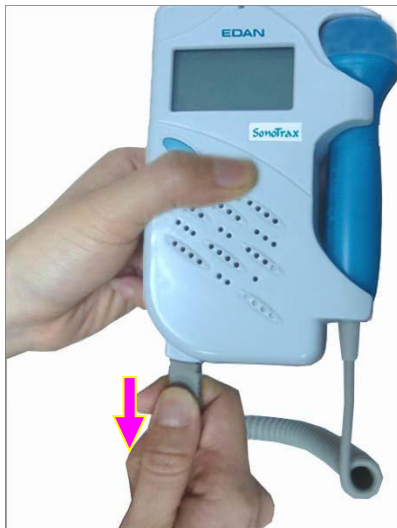
Figura 3-6 Rimozione della sonda
