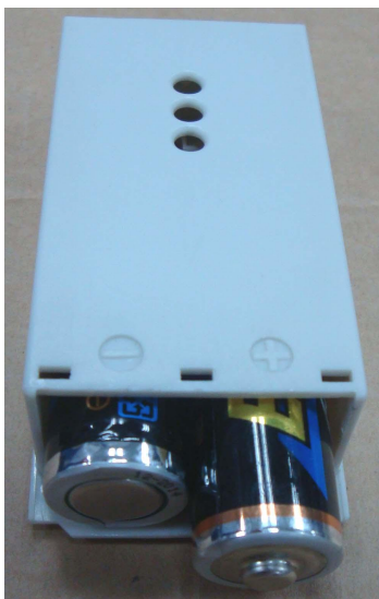
Figura 3-2 Inserimento delle batterie nel coperchio del vano batteria
