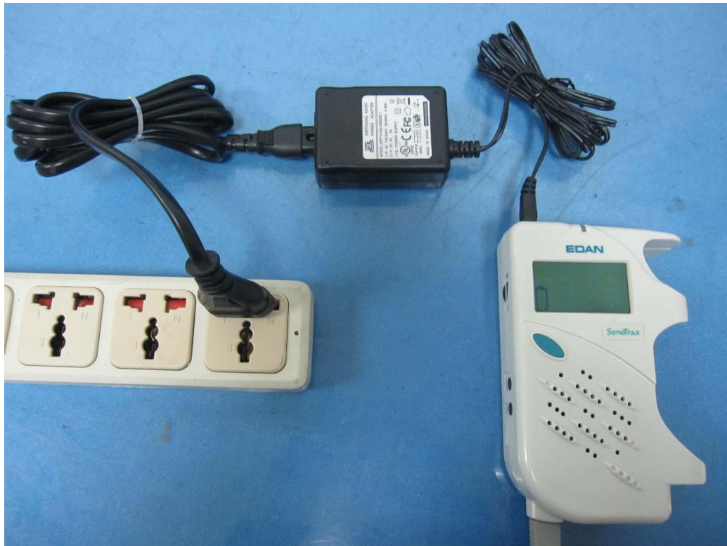
Figura 3-8 Recarga do pacote de baterias NI-MH
