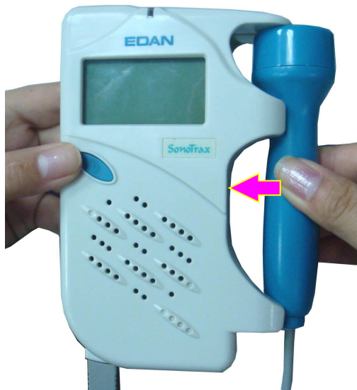
Abbildung 3-5 Anbringen der Sonde
