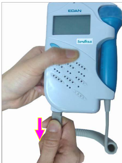
Figure 3-6 Débranchement de la sonde
