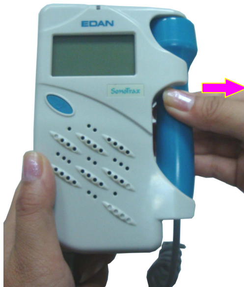
Abbildung 3-4 Herausziehen der Sonde
