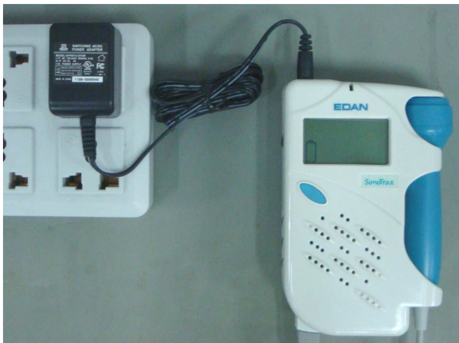
Рисунок 3-7. Зарядка блока никель-металлогидридных аккумуляторов
