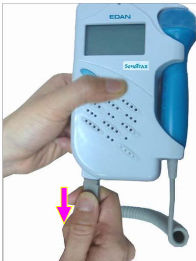
Figura 3-6 Remoção da sonda
