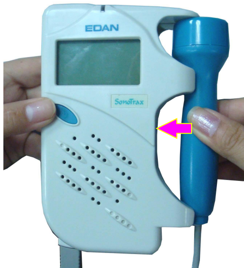
Figura 3-5 Colocação da sonda
