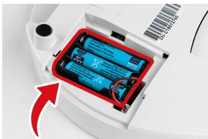
5. Aseta ensin alkaliparistokotelo ja aseta sitten kaapeli varovasti pohjassa olevaan syvennykseen
