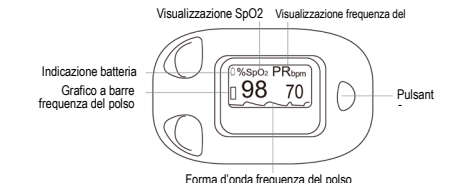
Figura 2 Interfaccia di misurazione
