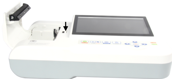
Figure 6 -1 Installation du papier d'enregistrement
