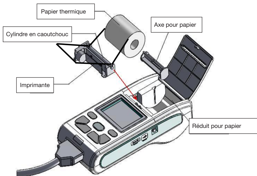
Schéma du chargement du rouleau de papier d'enregistrement
