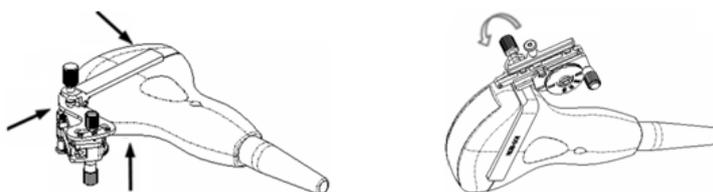
3. Gire a porca de fixação do suporte guiado por agulha para ter certeza de que o suporte esteja devidamente encaixado no transdutor.
