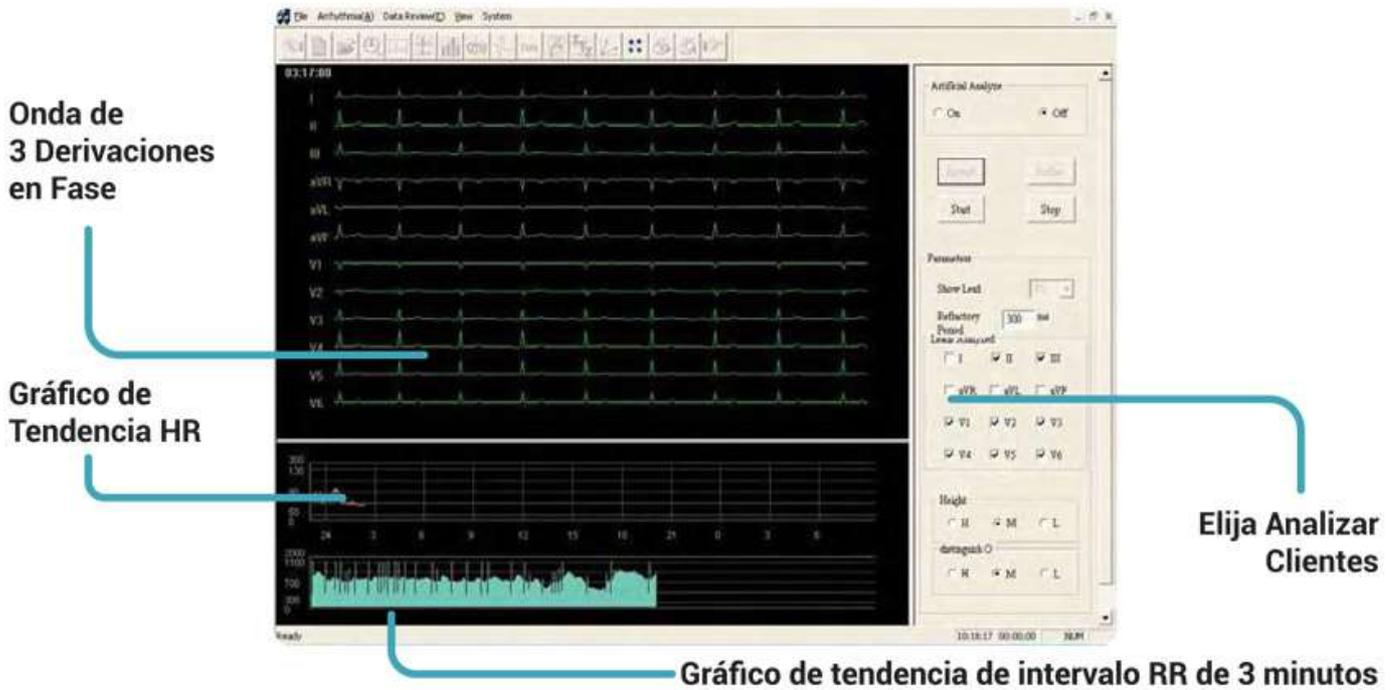
Haga clic en **Stop**, el sistema se detendrá temporalmente. El usuario puede navegar por el ECG de 12 derivaciones a través de "→↑←↓" en el teclado. En el gráfico de tendencia de la frecuencia cardíaca, hay una línea de símbolo verde, que representa el lugar de la onda actual. El usuario puede volver a un punto, cambiar la condición (pistas analíticas, discernimiento, discernimiento en disturbios), hacer clic **Start** en la parte detrás del letrero verde que se analizará nuevamente.
