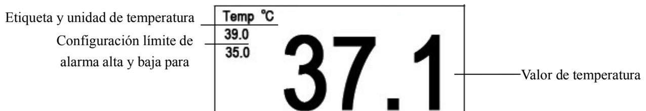
**Figura 4.2D Panel de temperatura**
