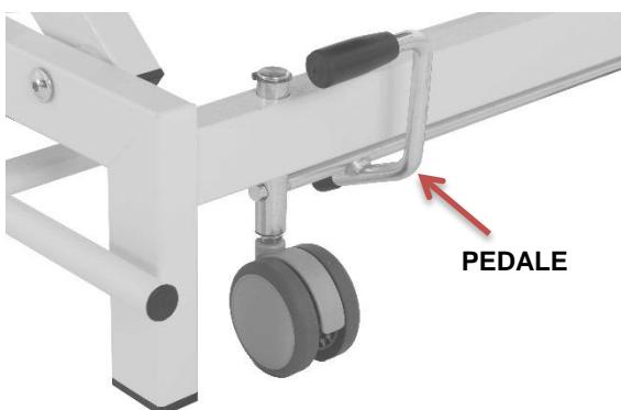
Per inserire le ruote retrattili spingere con la pianta del piede il PEDALE fino a fine corsa; per disinserire sollevare con il dorso del piede il PEDALE per far risalire le ruote.
