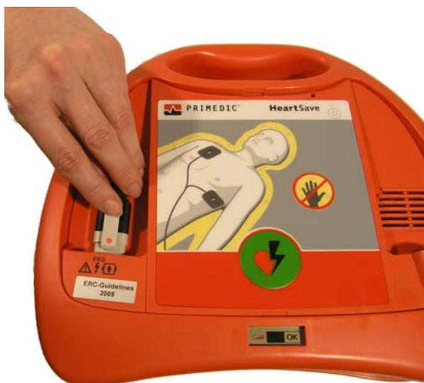
Fig. 12: Collegamento spinotto degli elettrodi
