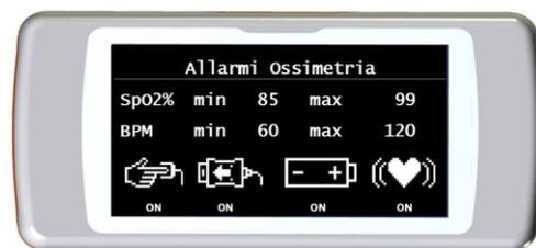
Dopo alcuni secondi il dispositivo torna alla schermata del menu di settaggio ossimetria.
