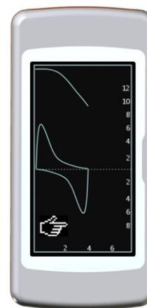
I test di ossimetria riportano i parametri scelti nel menu di servizio visualizzati alla stessa maniera dei parametri spirometrici sopra. Ad ogni schermata è possibile tornare al passo precedente utilizzando l'icona
