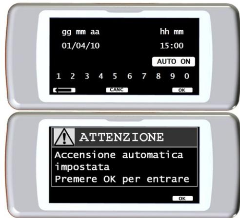
Impostata l'accensione automatica, accendendo il dispositivo in un orario differente da quello programmato, il dispositivo mostra il messaggio accanto; per proseguire toccare l'icona OK e verrà richiesto l'inserimento della password: 1 2 2 3 3 3; premendo il dispositivo si spegne.
