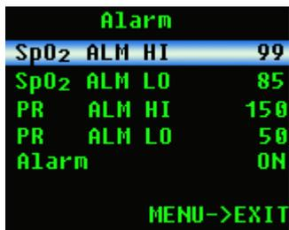
Fig. 9. Menú de Configuración de Alarma
