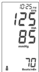
3. Nach der Messung wird im Bildschirm der systolisch- und diastolische Blutdruck sowie die Pulsrate angezeigt.
