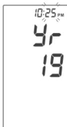
Wenn die Minute blinkt, solange **M** drücken, bis die korrekte Minute erscheint und dann mit der **i** Taste speichern.
