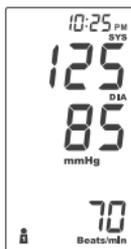
3. Dopo la misurazione, lo strumento indica la pressione sistolica, la pressione diastolica e la frequenza cardiaca.
