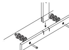
**Bitte beachten Sie:** Um den Messstab bei Benutzung nicht zu beschädigen, muss der Fersenanschlag unbedingt gegen die Wand abgestützt werden! Deshalb müssen Sie hinter dem Fersenanschlag so viele Distanzscheiben befestigen, dass die hintere an der Wand anliegt.
