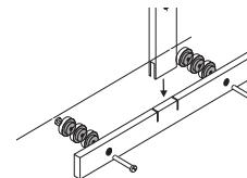
Attention: Pour ne pas endommager la règle lors de son utilisation, la butée doit absolument être appuyée contre le mur! C'est pourquoi il faut fixer des entretoises derrière la butée de sorte que l'arrière soit appuyé contre le mur.
