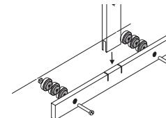
**Bemærk venligst:** For ikke at beskadige målepinden under brugen skal hælanslaget ubetinget støttes mod væggen! Derfor skal De befæste så mange afstandsskiver bagved hælanslaget, at den bagste skive ligger på mod væggen.
