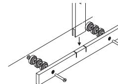
**Huom.:** Jotta mittauslatta ei vioitu käytössä, kantapäävaste täytyy ehdottomasti asettaa seinää vasten! Tästä syystä kantapäävasteen taakse täytyy kiinnittää niin monta välilevyä, että takimmainen levy tulee kiinni seinään.
