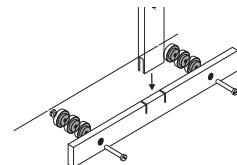
**Nota:** Para não danificar a barra de medição durante a utilização, é imprescindível apoiar o encosto para calcanhares na parede! Por isso é importante colocar anilhas distanciadoras suficientes de modo a que a última anilha fique encostada à parede.
