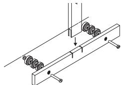
**Let a.u.b. op het volgende:** Om de meetlat bij het gebruik niet te beschadigen moet de hielaan slag in elk geval tegen de wand worden ondersteund. Daarom moet u achter de hielaan slag zoveel afstandsschijven bevestigen dat deze achter tegen de wand aanligt.
