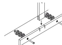
**Observera:** För att inte skada mätstaven vid användningen, måste hälanslaget ovillkorligen stötta mot väggen! Av denna anledning måste man lägga in så många distansbrickor bakom hälanslaget att det bakersta ligger an mot väggen.
