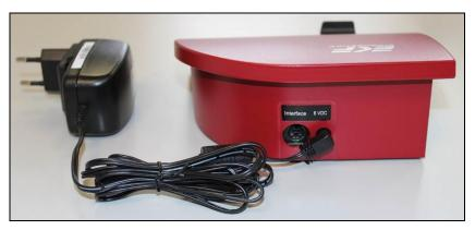
Figura 2 - Collegamento dell'alimentatore di rete
