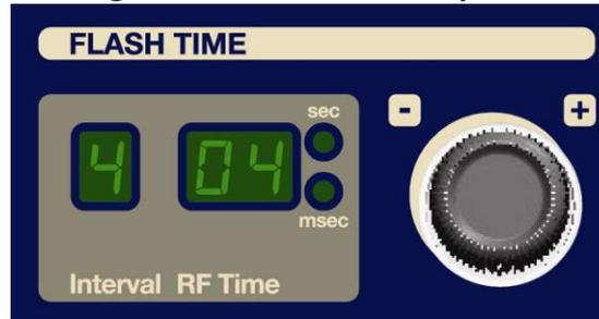
Nella sezione FLASH TIME è possibile selezionare la selezione del numero di ripetizione (INTERVAL) degli impulsi e la durata degli impulsi (RF TIME).
