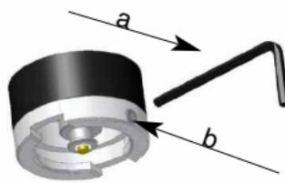
Установите нужную головку прибора на креплении в верхней части рукоятки так, чтобы обе выемки нижней части головки прибора совпали с обеими направляющими кулачками батареечной рукоятки. Слегка нажмите головку прибора и поверните рукоятку до упора по часовой стрелке.
