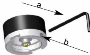
Montare la testa dello strumento desiderato sul supporto nella parte superiore del manico, in modo che le due scanalature della parte inferiore della testa si trovino sulle due camme di guida del manico portabatterie.
