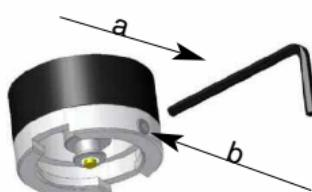
Setzen Sie den gewünschten Instrumentenkopf so auf die Aufnahme am Griffoberteil auf, dass die beiden Aussparungen des Unterteils des Instrumentenkopfes auf die beiden hervorstehten Führungsnocken des Batteriegriffes aufsitzen.
