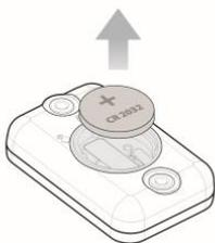
3. Orienter la pile avec le positif vers le haut (signe « + » visible). Retirer l'adhésif de protection de la batterie, si présent.
