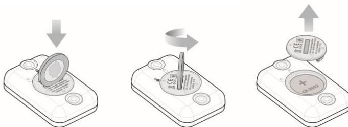
2. Retirer la pile usagée et la remplacer par une pile identique (pile plate 3V CR2032).
