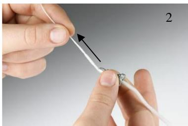
Después de limpiar cuidadosamente los canales, monte la sonda. Introduzca la punta fija de la sonda en el cuerpo principal, teniendo cuidado de alinear la guía A, situada en el cuerpo, con el orificio B, presente en la punta fija, como se muestra en la figura de abajo. Luego enrosque el casquillo.
