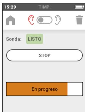
Si se producen pérdidas de presión, el dispositivo trata de realizar un barrido bajo presión hasta tres veces antes de señalar el problema. Si no fuera posible realizar la prueba por pérdida de presión, intente sustituir la oliva por una de tamaño diferente y/o intente cambiar la posición y la dirección de la sonda dentro del canal auditivo.
