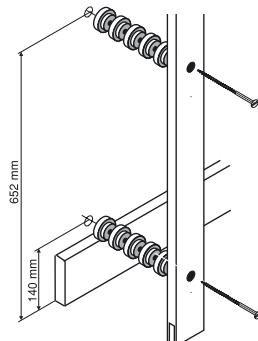
**Bitte beachten Sie:** Um den Messstab bei Benutzung nicht zu beschädigen, muss der Fersenanschlag unbedingt gegen die Wand abgestützt werden! Deshalb müssen Sie hinter dem Fersenanschlag so viele Distanzscheiben befestigen, dass die hintere an der Wand anliegt.
