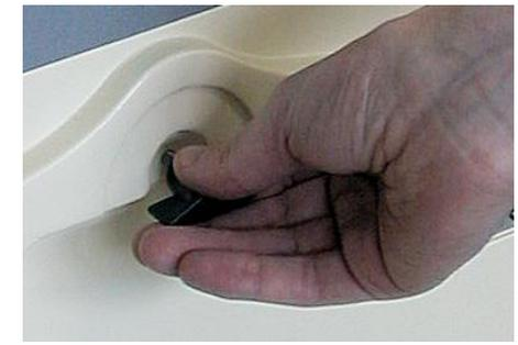
**3** Dall'interno del corpo, inserite il dado di bloccaggio della vite e, tenendo ferma la vite, serrate.
