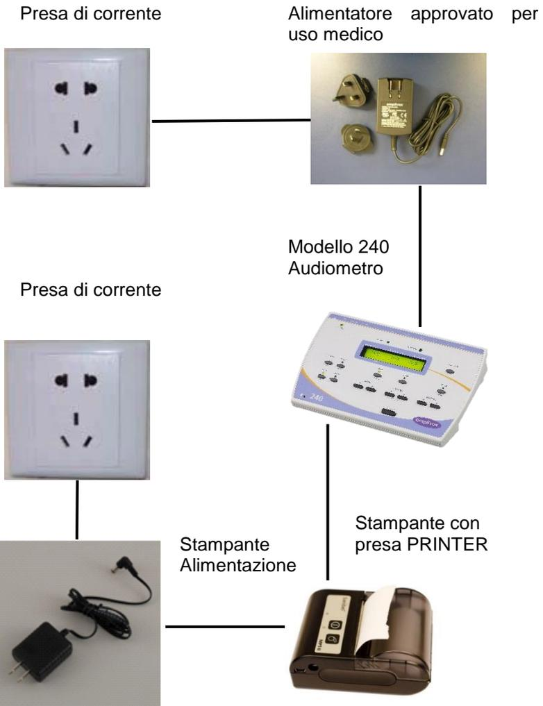
Schema 3: Modello 240 utilizzato con l'alimentatore approvato per uso medico e il PC
