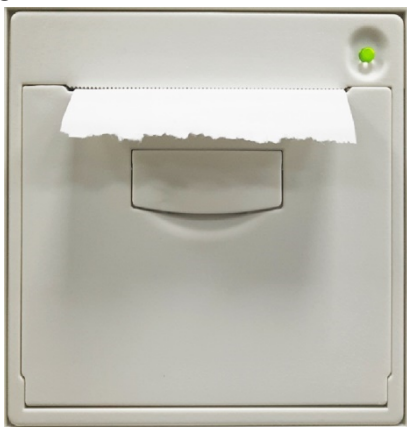
Figura 2-6 Installazione della carta termica (3)
