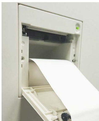
Figura 2-5 Installazione della carta termica (2)
