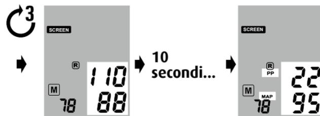
6) Premere il pulsante M per rilevare i valori della seconda e prima misurazione dell'ultima serie di misurazioni effettuata.
