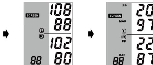
※ *Al termine delle misurazioni, la misurazione del braccio con il valore più alto lampeggerà continuamente per 5 secondi. Se non c'è una differenza significativa (20mmHg per la pressione sistolica o 10 mmHg per quella diastolica) fra le due braccia, non lampeggerà nessuna misurazione.*
