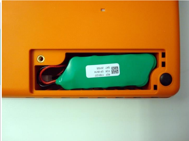
4. Posizionare la batteria nell'alloggiamento.
