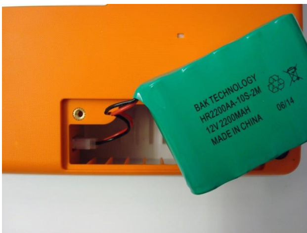
3. Collegare la nuova batteria.
