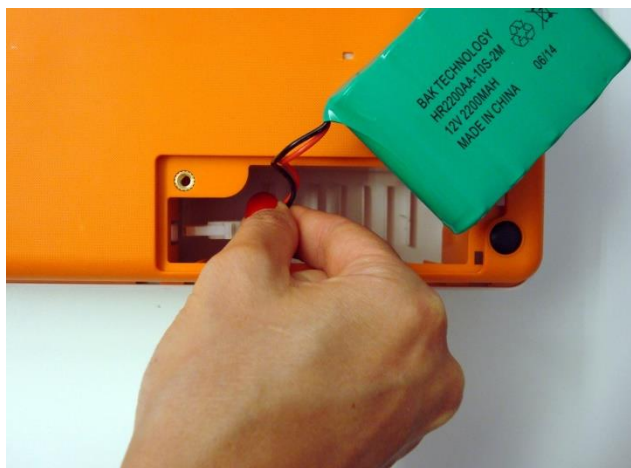
2. Scollegare il connettore batteria.
