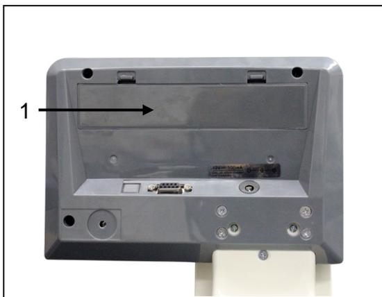
Aprire il coperchio del vano accumulatore (1) nel basso del display e collegare l'accumulatore. Prima del primo uso l'accumulatore va caricato per almeno 12 ore.
